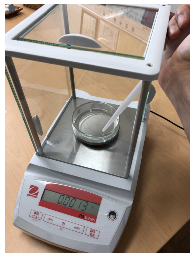
写真 風防付きの精密電子天秤
